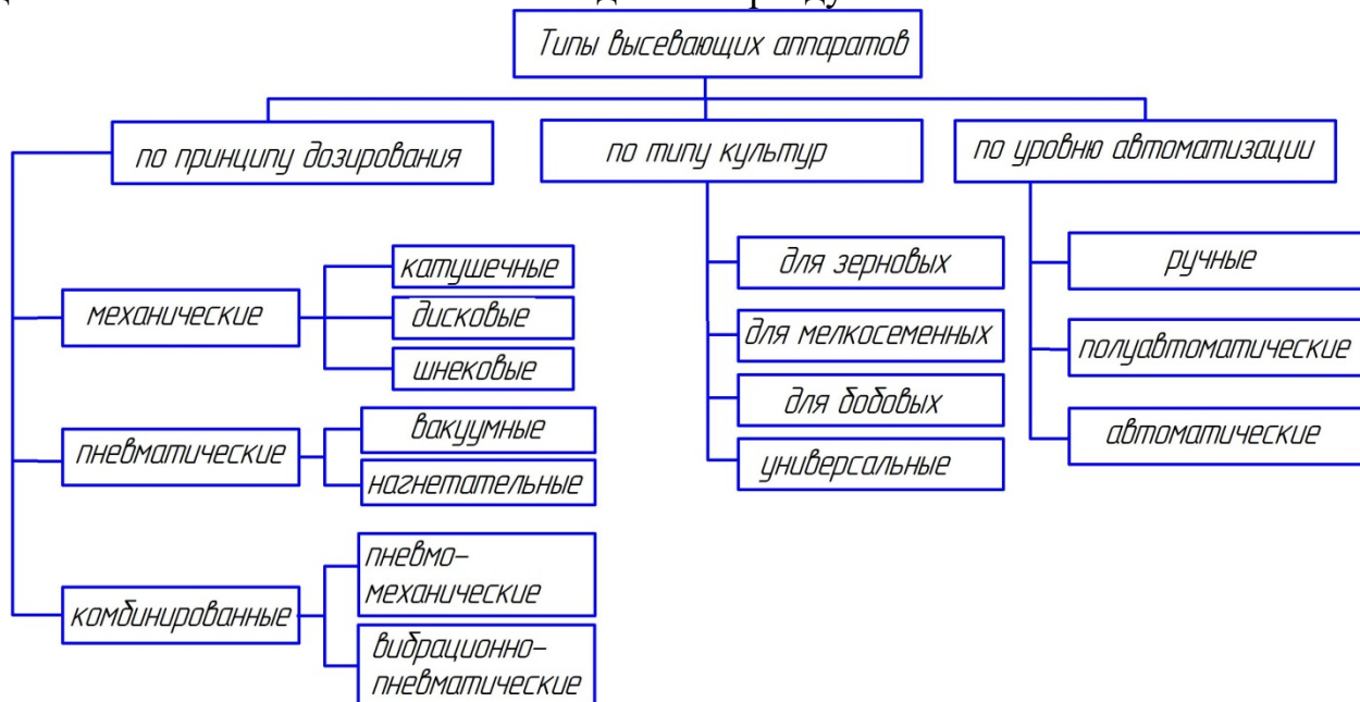
Рисунок 1. Классификация селекционных высевальных аппаратов
