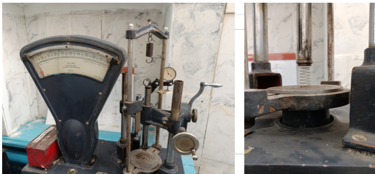
Рисунок 2. Машина для испытаний пружин МИП-10; а – вид общий, б – схема установки образца пружины для проведения испытаний
