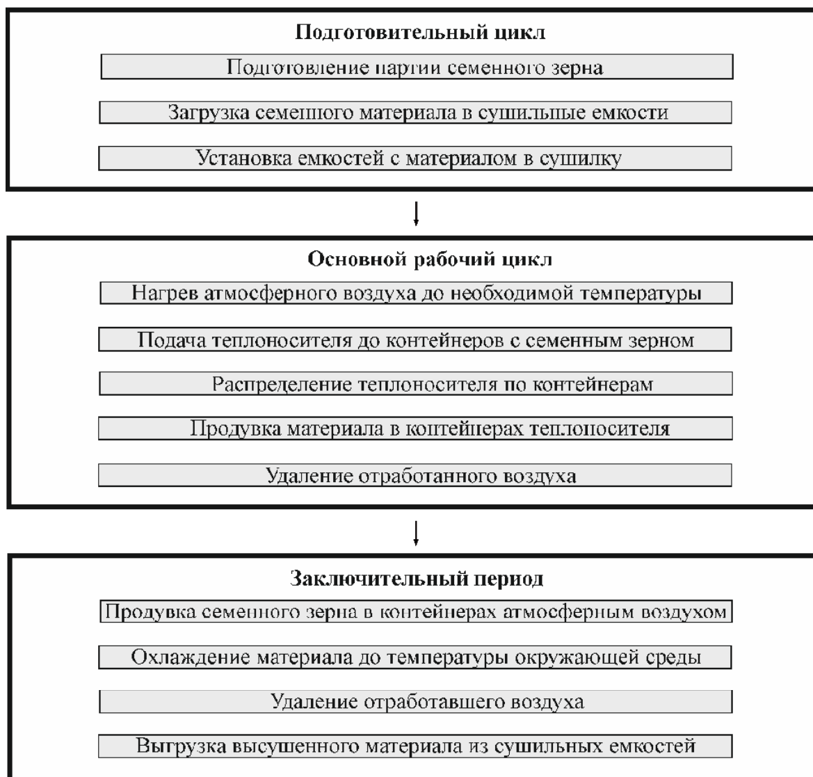
Рисунок 1 – Технологическая схема контейнерной сушки семян зерновых культур
