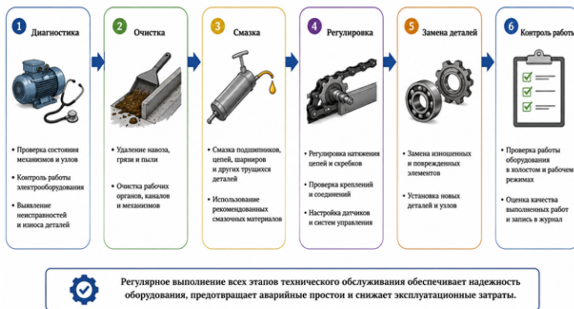
Рисунок 4. Этапы технического обслуживания навозоуборочной техники
