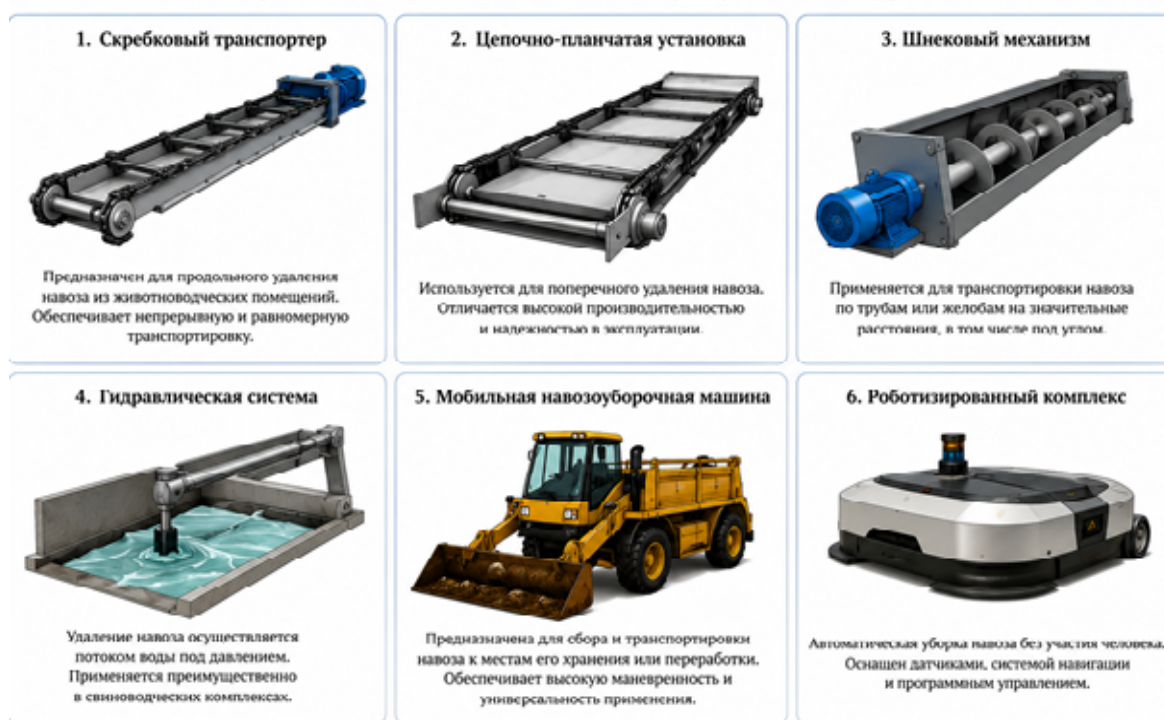
Рисунок 2. Основные виды навозоуборочного оборудования
