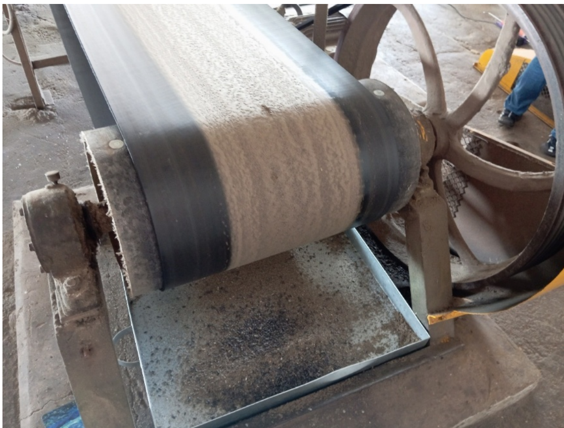
Рисунок 1. Формирование связно-пластичного слоя загрязнения на рабочей обкладке конвейерной ленты при транспортировке подсолнечника
