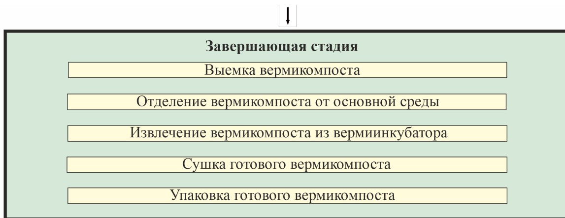
Рисунок 1. Технологическая схема производства вермикомпоста
