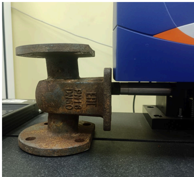
Рисунок 5. Корпус клиновой задвижки, установленный на профилографе-профилометре
