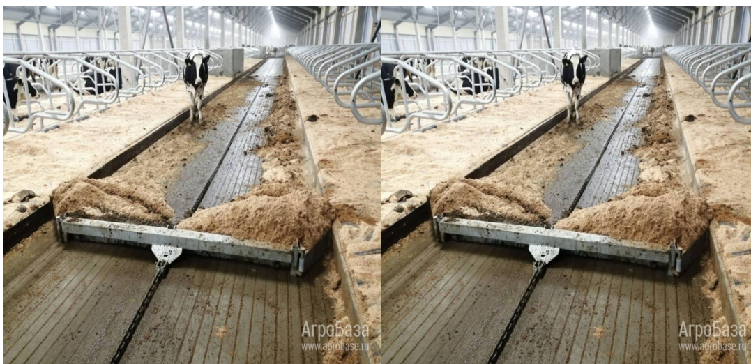
Рисунок 5. Роботизированная установка для автоматической уборки навоза
